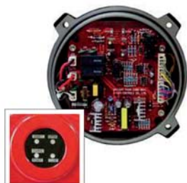
A prueba de falla ( Retorno por baterías)
